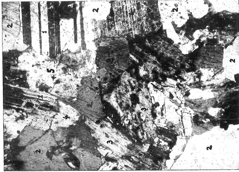
Fig. 1.—Muestra 2. Paraje de las Lavanderas cerca de Alcuéscar. Granito de grano gordo de dos micas.— 1, plagioclasa; 2, cuarzo; 3, biotita; 4, moscovita. Con polarizador y analizador cruzados. Aumento aproximado, 50 diámetros.
